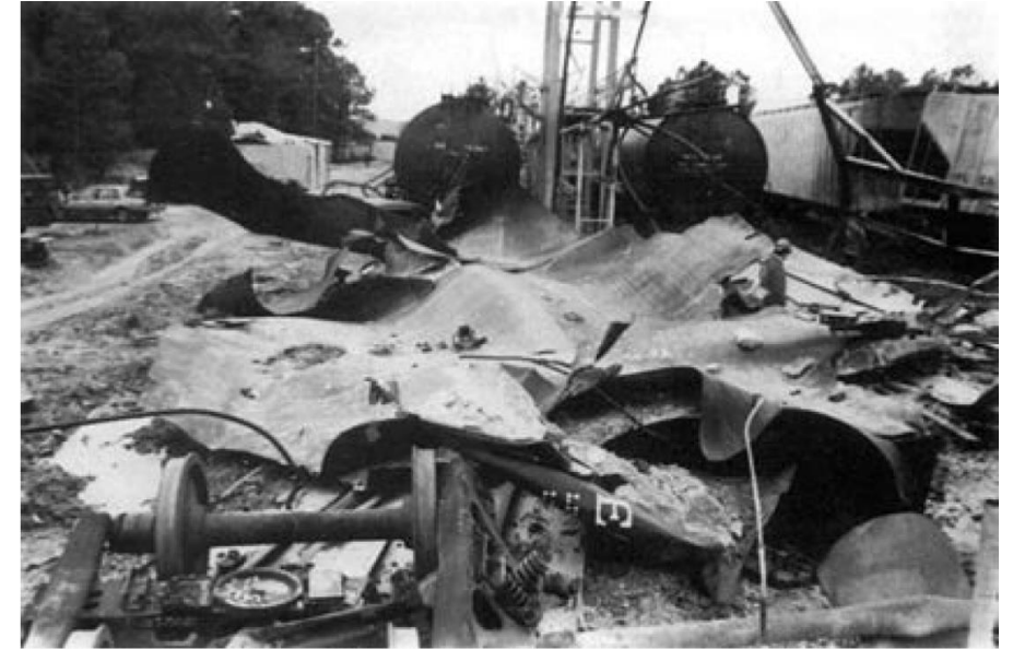
FIGURA 23.2.2.3 Un Vagón Cisterna con Butadieno que ha Sufrido un BLEVE por el Calor creado por una Reacción Química Interna.
